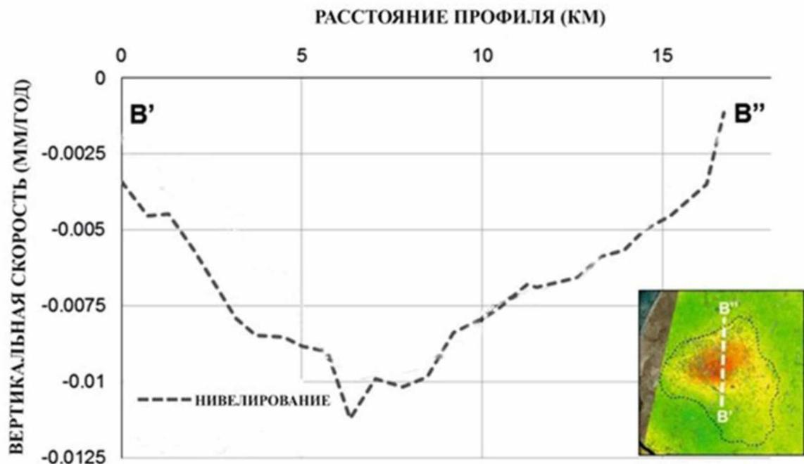
Рисунок 8 – Нормированные по продуктивности деформации Тенгизского пласта
